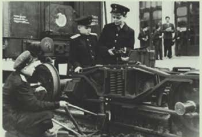
Малая Южная железная дорога, г. Харьков. Юные железнодорожники за ремонтом тележки пассажирского вагона. 1947г.
